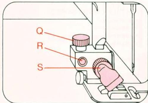
Q und R sind zum Zubehör befestigen. S ist die Nähfußhalterschraube.
