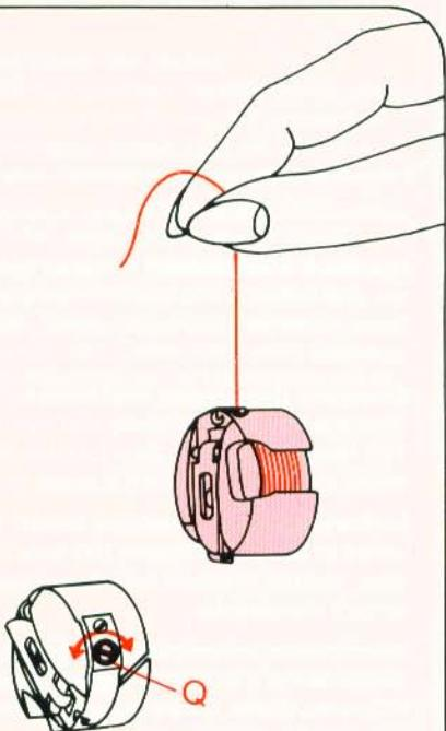
**Unterfadenspannung prüfen:** Kapsel leicht, ruckartig aufwärtsbewegen. Sie muß stufenweise niedersinken. (Einstellschraube Q nach links drehen = loser, nach rechts drehen = fester).
