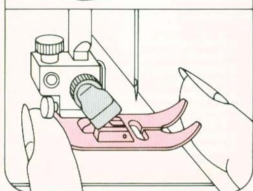
**Nähfuß anbringen:** Stoffdrückerhebel senken und den Fuß dabei so schieben, daß der Steg O in die Nuten P einrasten.
