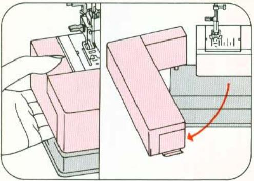
Unter die Nähfläche greifen und diese nach links schwenken.
