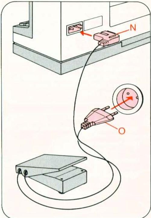
**Elektrischer Anschluß:** Anlasser auf den Boden stellen. Stecker N in die Maschine, und Stecker O in die Wandsteckdose stecken.
