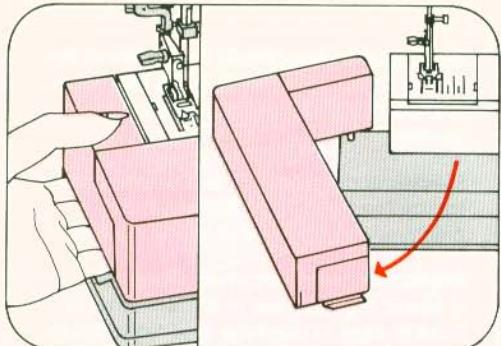
**Spulen vorbereiten:** Unter die Nähfläche greifen und diese nach links schwenken.
