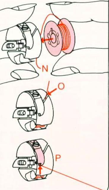
**Spule einlegen N** (Faden nach hinten). Den Faden in den Schlitz O und bis zur Öffnung P ziehen.
