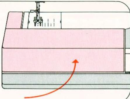
Nähfläche 107 an die Maschine schwenken.
