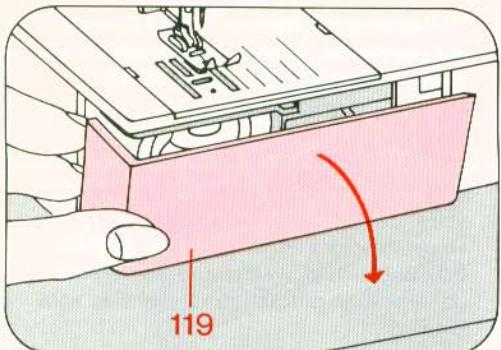
Verschlußklappe 119 nach unten öffnen.
