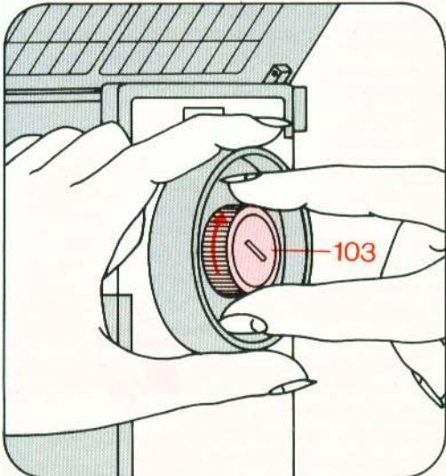
**Nähwerk einschalten:** Handrad festhalten und Scheibe 103 nach hinten drehen. Dann Handrad nach vorne drehen, bis es einrastet.
