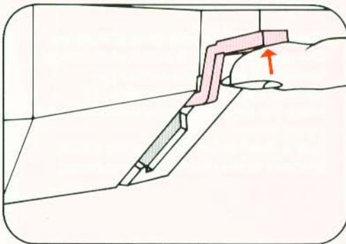
Beim Einlegen extrem dicker Stofflagen Hebel 112 höher anheben.
