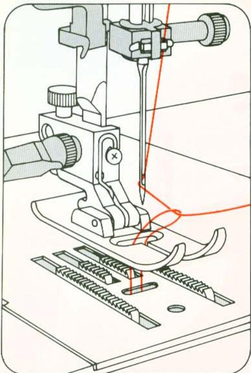
Oberfaden festhalten. Handrad nach vorn drehen und einen Stich nähen. Nadel und Fadenhebel müssen wieder oben stehen. Mit dem Oberfaden den Unterfaden nach oben ziehen.
