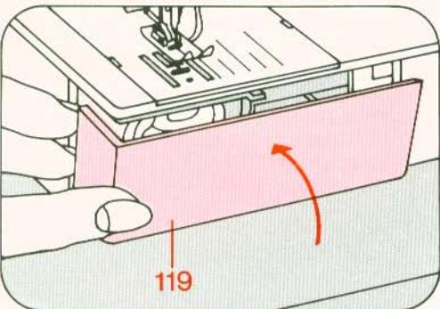
Verschlußklappe 119 nach oben schließen.
