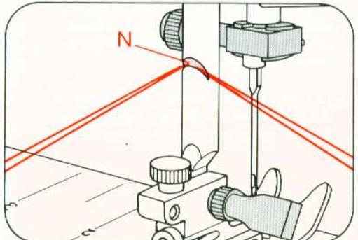
Fadenabschneider N. Fäden einlegen und nach unten ziehen.
